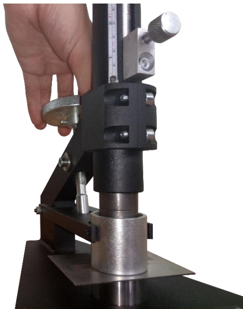
Рисунок 2.4 – Установка образца на наковальню
