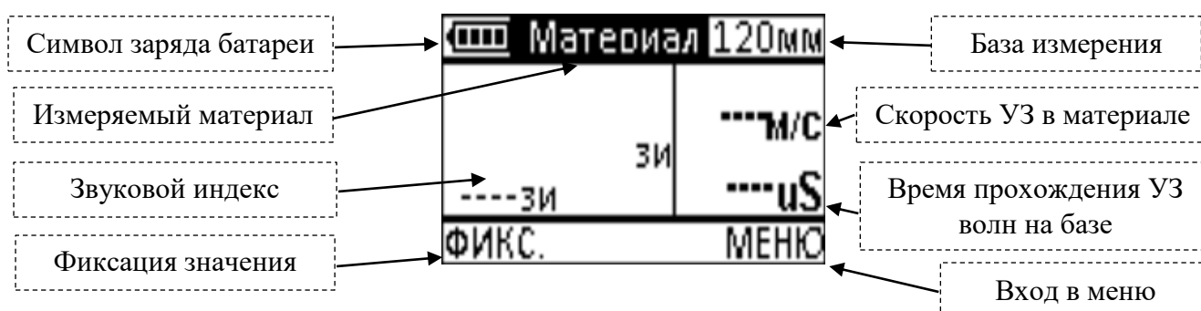
Рисунок 2.7 – Режим измерения звукового индекса
