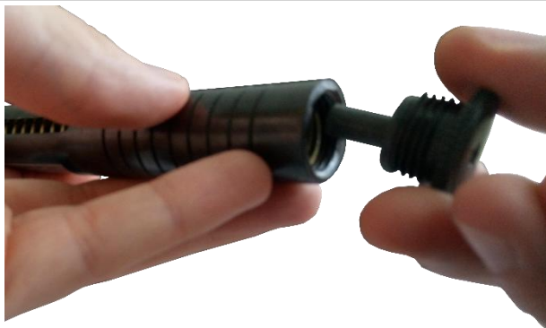
Рисунок 2.3 – Вкручивание заглушки с индентором Примечание: Для установки пружины № 1 (короче) необходимо на индентор установить дополнительную втулку.
