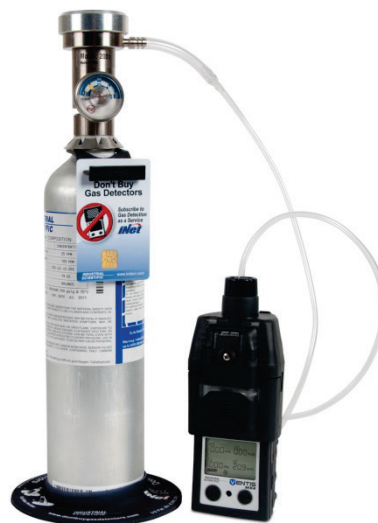
Проверка в режиме принудительного отбора проб с корректировкой по расходу газоанализатора
