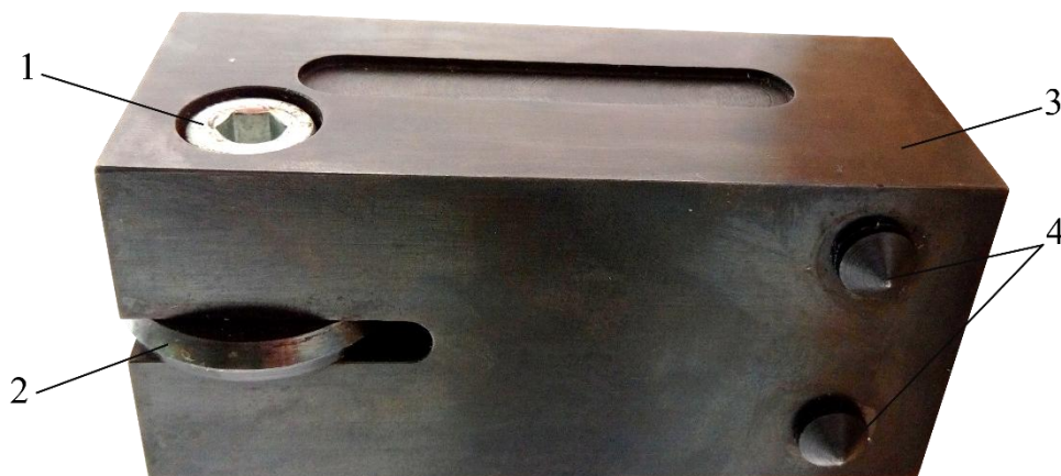
1 – винт фиксации индентора; 2 – индентор; 3 – корпус; 4 – заостренные ножки.
