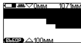
Рисунок 1.5 – Режим отображения с выводом В-Скана
