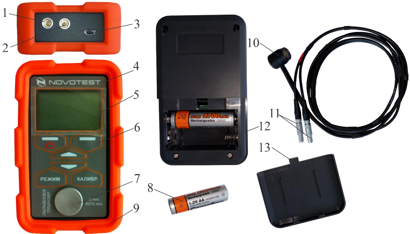
1 – разъем генератора; 2 – разъем приемника; 3 – разъем miniUSB; 4 – электронный блок; 5 – графический индикатор; 6 – клавиатура; 7 – эталонная мера; 8 – аккумулятор типа AA; 9 – защитный силиконовый бампер; 10 – преобразователь; 11 – штекеры преобразователя; 12 – отсек размещения батареи; 13 – крышка отсека размещения батареи.
