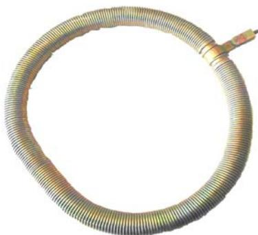
покрытий труб диаметрами от 133 до 1420 мм в составе электроискрового дефектоскопа. Сборная конструкция электрода позволяет набирать длину пружины на требуемый диаметр трубы.
