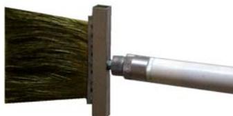
Предназначен для определения мест нарушений сплошности тонких и непрочных изоляционных покрытий в составе электроискрового дефектоскопа.
