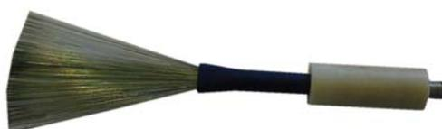
Предназначен для определения мест нарушений сплошности изоляционных покрытий в составе электроискрового дефектоскопа. Конструкция и применяемые материалы обеспечивают неповреждаемость покрытий с малой механической прочностью.
