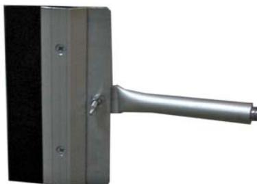
Предназначен для определения мест нарушений сплошности изоляционных покрытий в составе электроискрового дефектоскопа.
