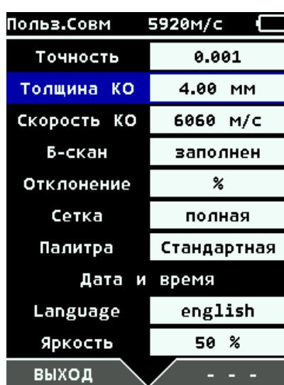
Рис.6-14 Установка параметров стандартного образца
