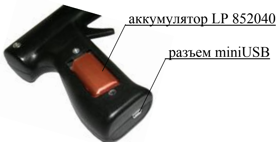
Рисунок 1.2 – Вид рукояти преобразователя
