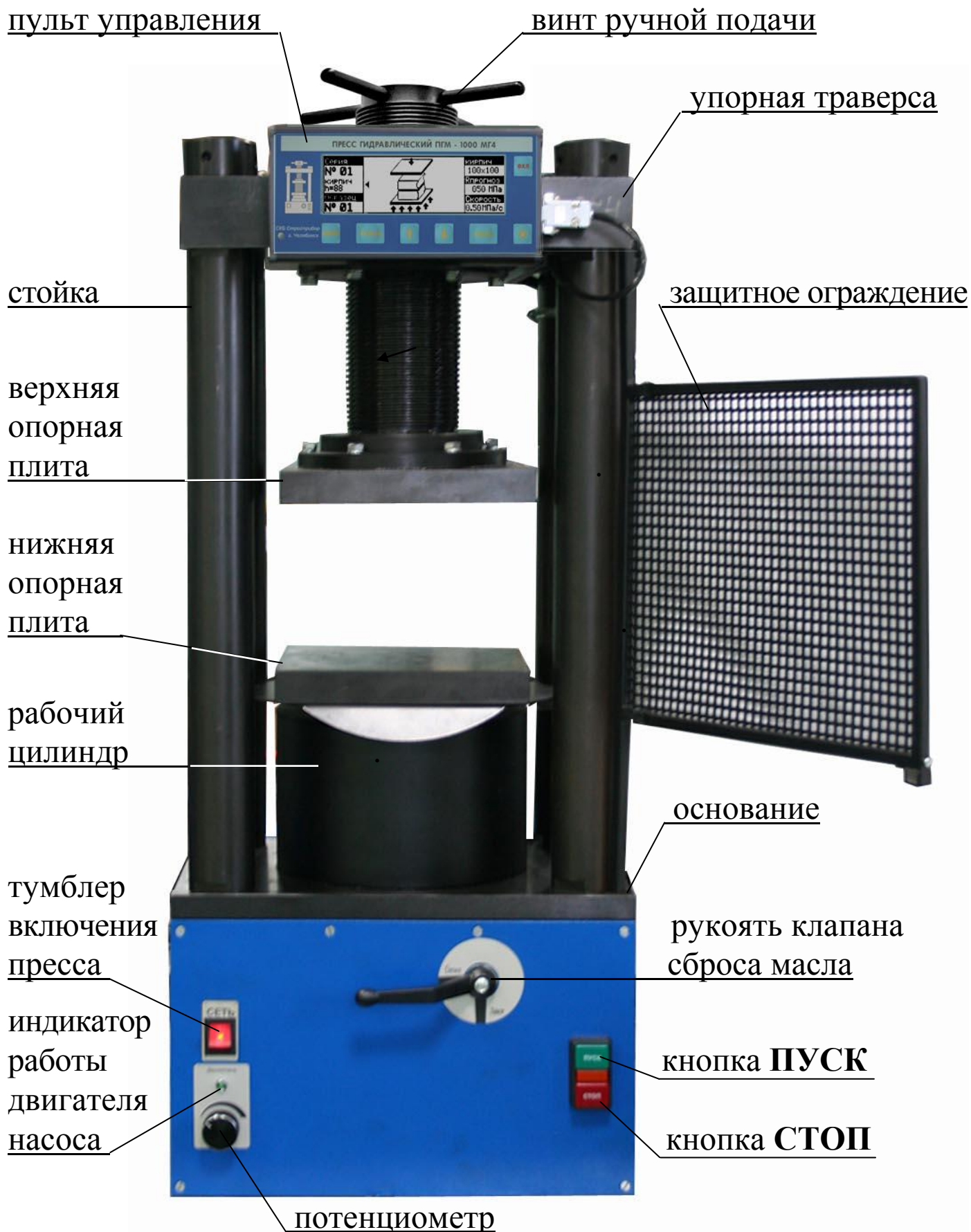
Рисунок 1.а – Внешний вид пресса. Вид спереди
