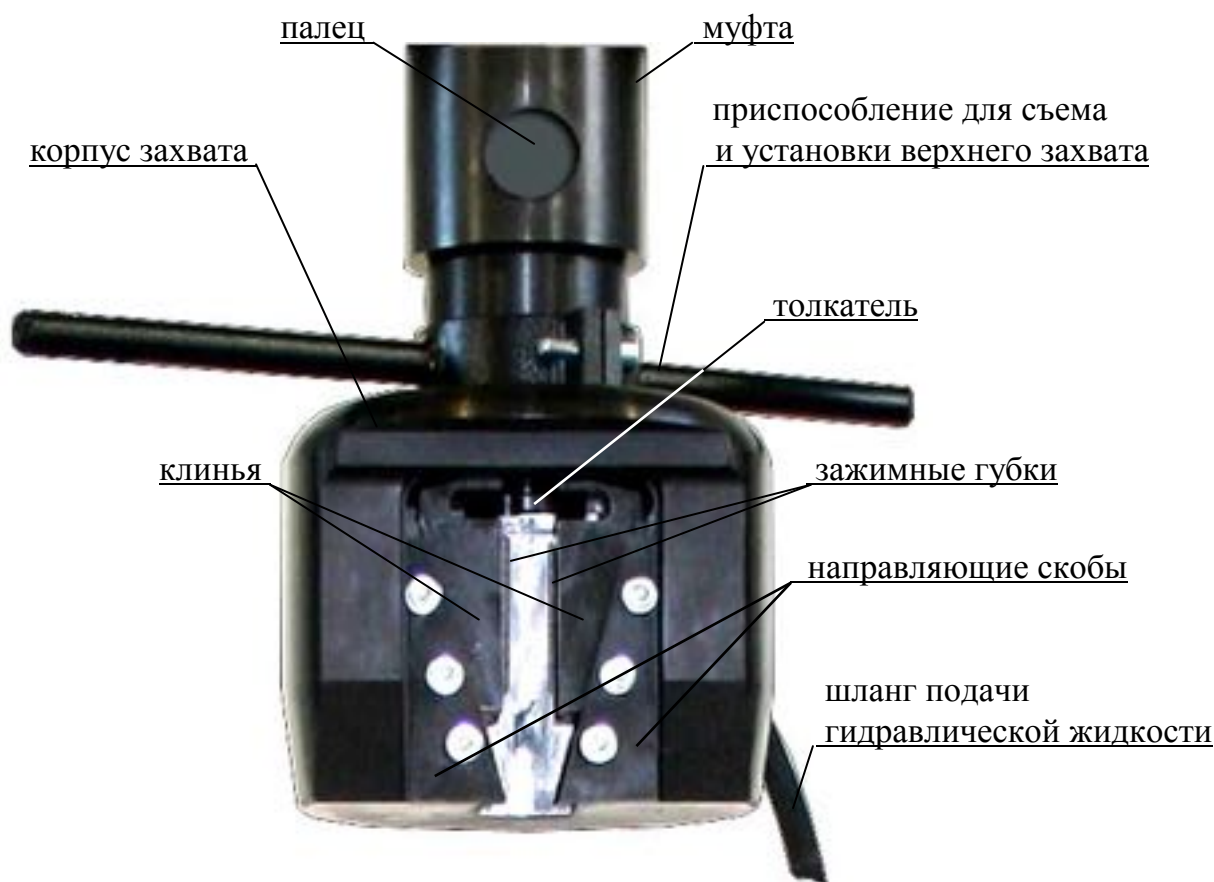
Рисунок 3 – Общий вид клинового захвата
