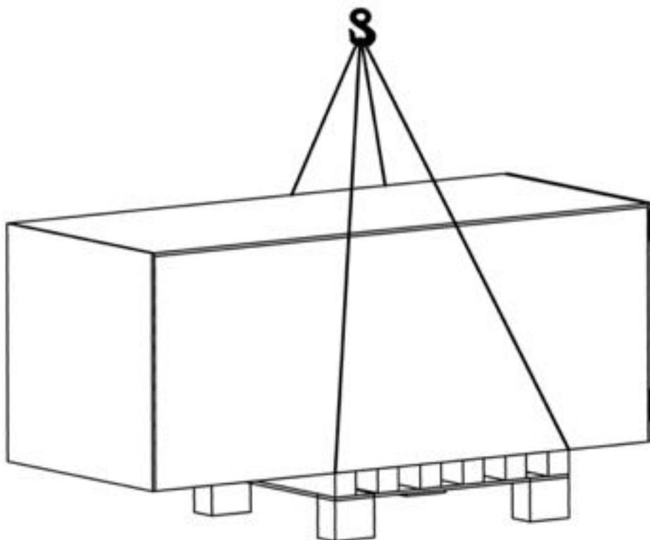
Рисунок 2 – Схема транспортировки машины в упаковке
