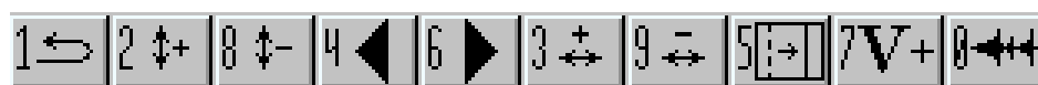
Рисунок 5 – Пример размещения пиктограмм в нижней части дисплея для обозначения функционального назначения клавиш в данном режиме работы прибора
