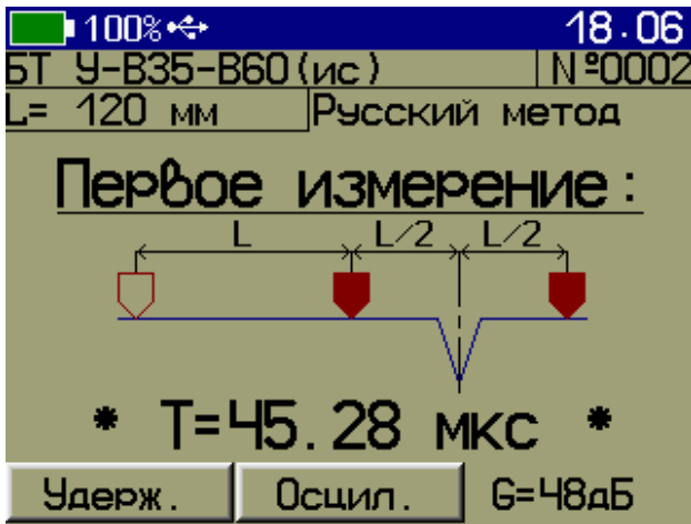
«Русский метод» измерения глубины трещины
