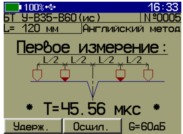
«Английский метод» измерения глубины трещины
