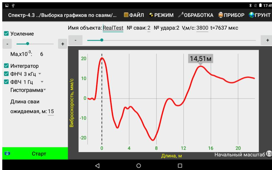
Для определения длины сваи по графику виброскорости во временной области будут доступны два маркера.
