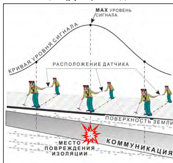
применение датчика-определителя дефектов коммуникации (ДОДК) методом max
