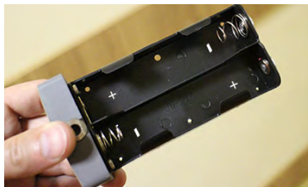
б) Вставить батарейки, соблюдая полярность
