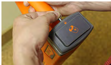
а) Потянуть за фиксатор и освободить батарейный отсек
