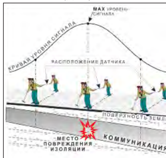
применение датчика-определителя дефектов коммуникации (ДОДК) методом max
