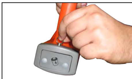
а) Выдвинуть фиксатор освободить батарейный отсек
