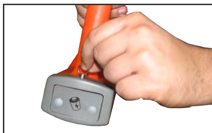
а) Выдвинуть фиксатор, освободить батарейный отсек
