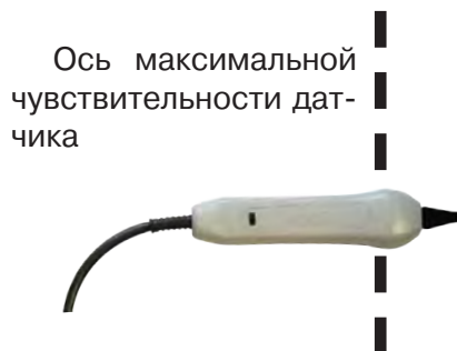
Выбор кабеля по максимальному сигналу
