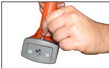
а) Выдвинуть фиксатор, освободить батарейный отсек
