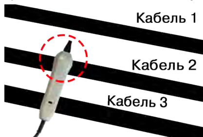
Выбор кабеля по максимальному сигналу
