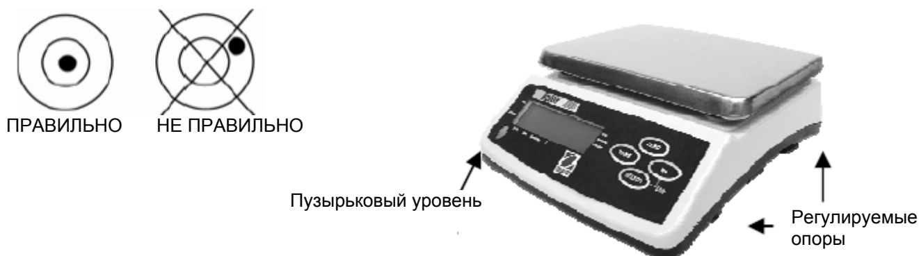
Рис. 2-1. Выравнивание весов в горизонтальной плоскости.
