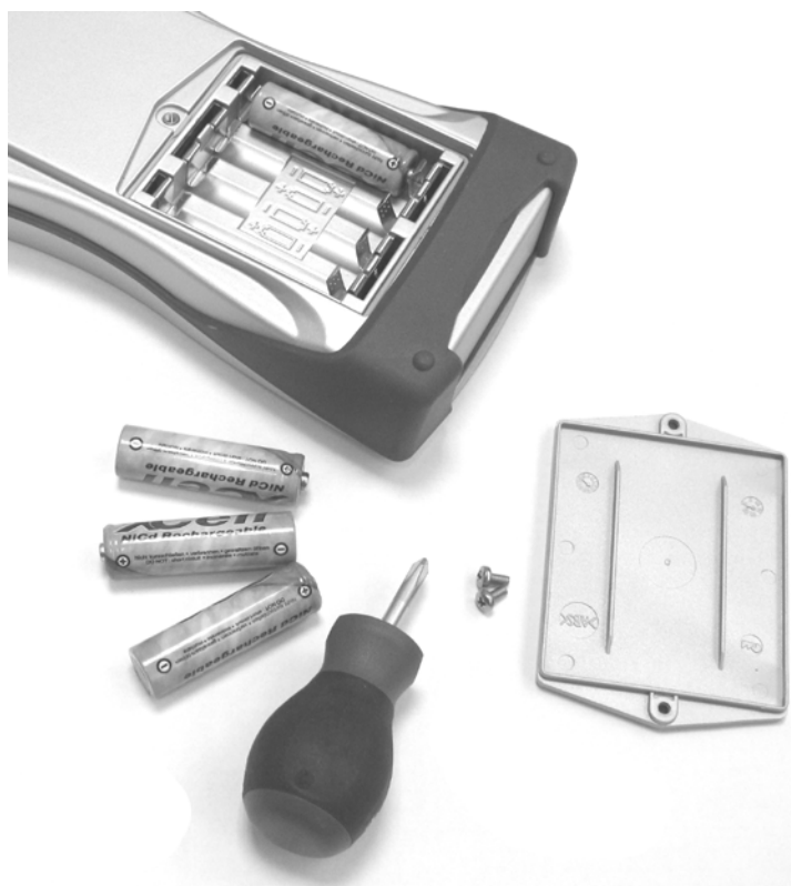
Рисунок 2: ZFG 3.0 с открытым отсеком для батарей
