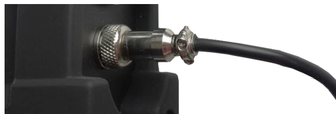
Рисунок 2.5 – Подключение к зарядному устройству
